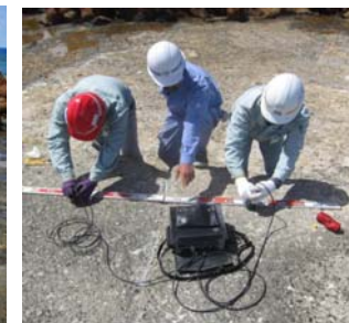
護岸コンクリート部の調査
