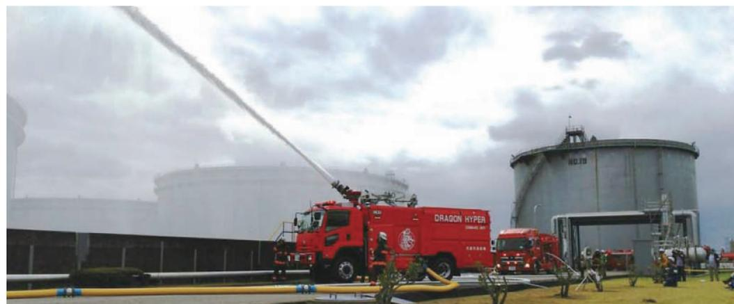
大型放水砲車 最長100m先の火点に対し、毎分8000ℓの大量放水が可能
