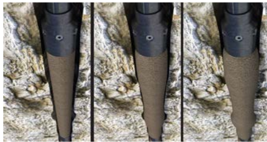
グラベルを固化する膨張性の樹脂ポリマー(GeoForm)(太い部分)
