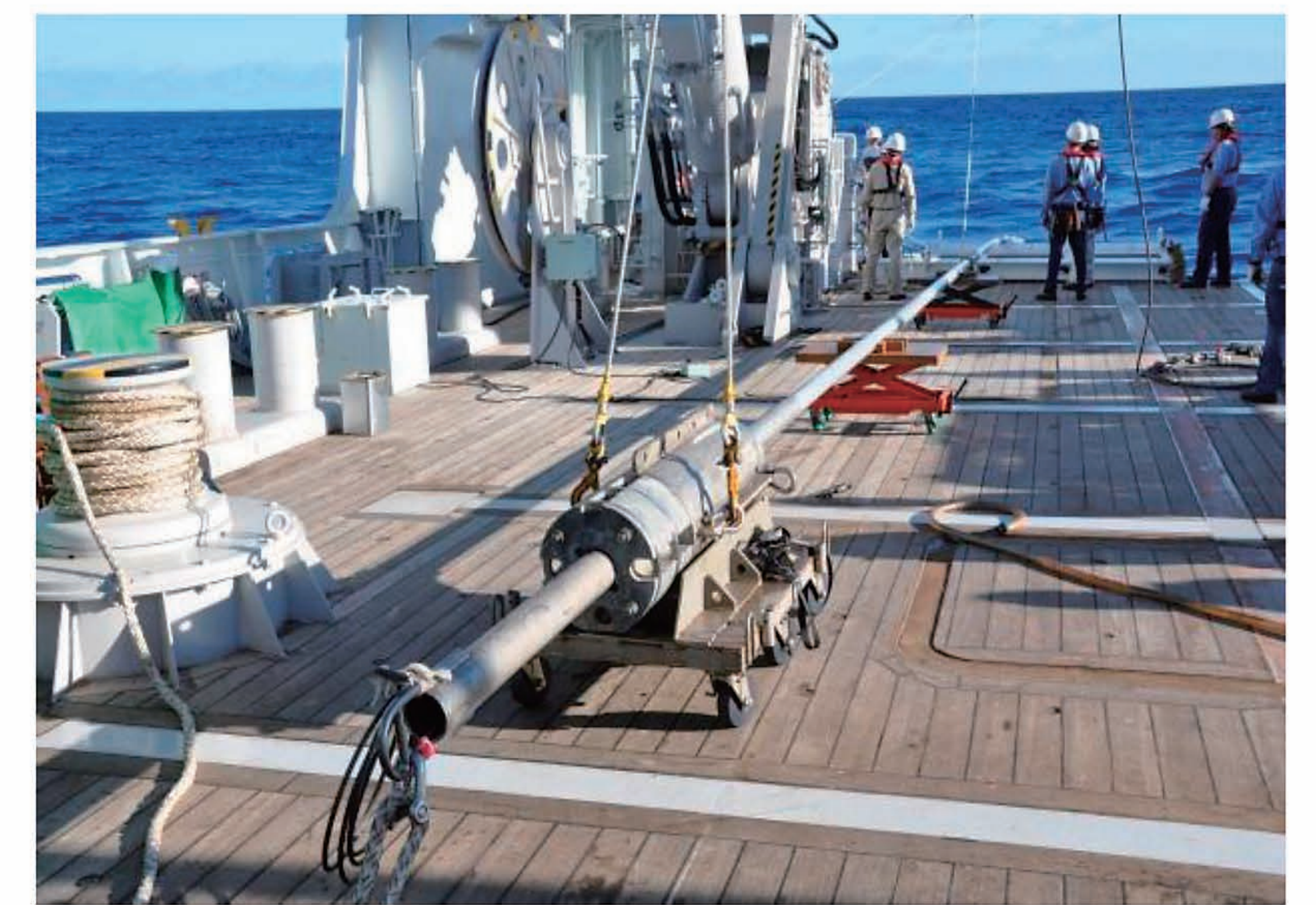
海底下の泥を採取する ピストンコアラー (全長20m) (出典: JOGMEC)
